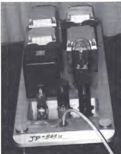
De ook in Nederland bekende VAL versterker, mono met vijf trafo's!
